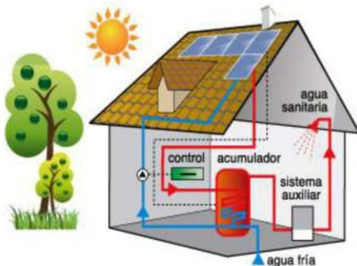
Los Kits fototérmicos EISSA, constan de un arreglo de captadores solares, que utilizan la energía del sol para calentar el fluido que atraviesa los captadores. Este fluido cederá el calor ganado, al ponerse en contacto con el agua fría proveniente de la red. De esta forma se logra calentar el agua fría de la red, para los fines que se estime conveniente.
