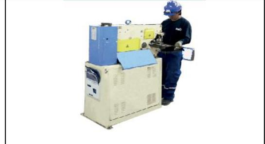
Contamos con máquinas especiales para el doblado de diferentes piezas como: platinas de cobre, ángulos, etc. Con espesores desde 3mm hasta 10mm.
