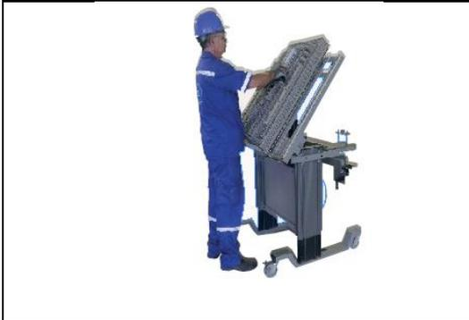
La etapa del cableado se realiza de acuerdo a los planos eléctricos revisándose las conexiones en su totalidad, al finalizar el cableado se hacen las respectivas pruebas como: FAT, SAT, Continuidad, Amarillado, etc.
