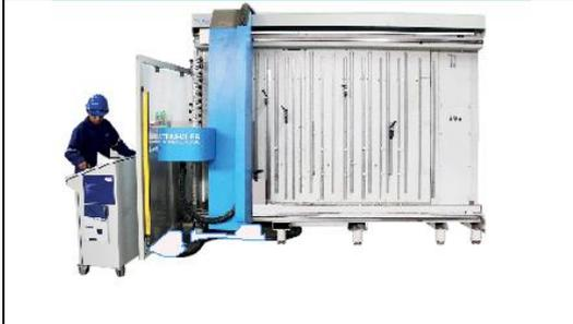
EISSA cuenta con un Work Center de STEINHAEUER que cuenta con 3 ejes con centro de mecanizado CNC, permitiéndonos trabajar de manera integral la parte externa de los tableros eléctricos brindándonos precisión en las perforaciones, fresado y grabado, siendo muy utilizados en calados para paneles, ventiladores, display, pulsadores, etc. Además de su alta escalabilidad puede perfectamente adaptarse a necesidades especiales ya que su alta frecuencia hace posible el mecanizado.
